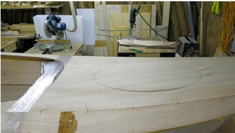
ハッチを下から支える台木の上に、ハッチサイズのスペーサーを挟みこんでデッキ内側に接着します。ハッチと支えの間に合板一枚分の隙間ができますが、ここには防水ゴムなどを張るのでそれでちょうどデッキと面一になります。手持ちのクランプを動員してエポキシで接着。
