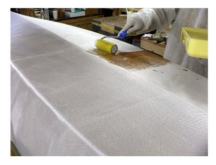
心配していたよりずっと楽にエポキシは浸透していきますし、幸いなことにチャイン部の丸みにもファイバーグラスがピッタリ張り付き、浮くことはありませんでした。スロー硬化剤を混ぜてあるのでこの室温でもワーキングタイムは30分を超え、全体に塗布した後スキージとスポンジによる仕上げのための十分な時間を取ることができました。
