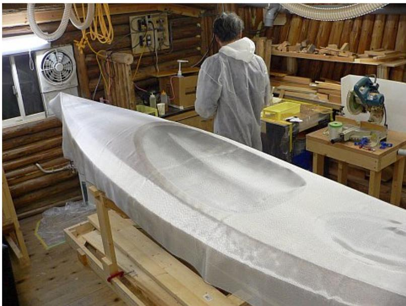
ファイバーグラスをデッキに被せ、サイドパネルまで5cmほど巻き込んでグラッシングします。コックピットとハッチの穴は硬化始めたらナイフで切り取ります。
